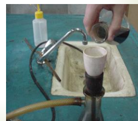
(4) Filtragem com auxílio de vácuo Em tricloroetileno NBR 14855
