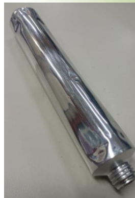
Tubo alumínio utilizado no ensaio de separação de fase
