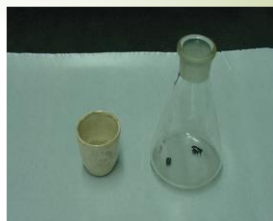
(2) Cadinho com papel filtro (esq) Amostra antes da filtragem (dir)
