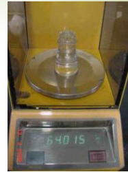
(2) Massa do picnômetro com água a 25°C
