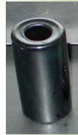
Recipiente coberto após ensaio RTFOT
