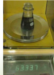
(4) Massa do picnômetro com metade asfalto e metade água
