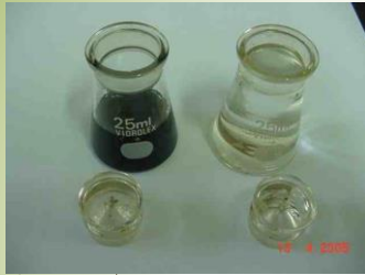
(1) Picnômetros com asfalto e com água
