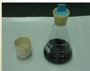
(3) Amostra dissolvida em tricloroetileno
