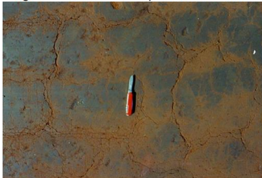
Figura 5 – Solo arenoso imprimado com CM-30
