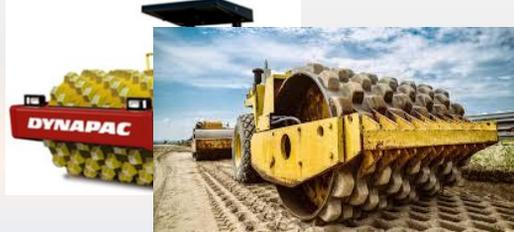
A "pata" do rolo, penetra na superfície e atinge a parte inferior da camada e propicia a densificação de baixo pra cima.
