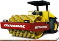
Normalmente, tem-se utilizado a compactação com rolo pé de carneiro sem vibração para materiais empregados em camada de reforço de subleito – solo fino
