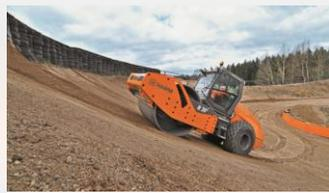
Rolo com cilindro chapa no eixo dianteiro e pneus no eixo traseiro (pneu/chapa), para materiais que apresentam baixa coesão superficial, o atrito pneu/superfície, propicia uma maior dirigibilidade do rolo, inclusive atuam em rampas acentuadas.
