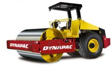
Atuam na superfície da camada com pressões estáticas de diferentes magnitudes. A eficiência da densificação é função do peso próprio do rolo.
