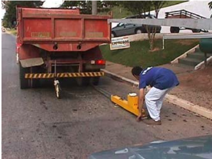
Foto 01 – Posicionamento da viga Benkelman
