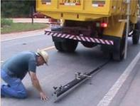
Posicionamento da viga Benkelman
